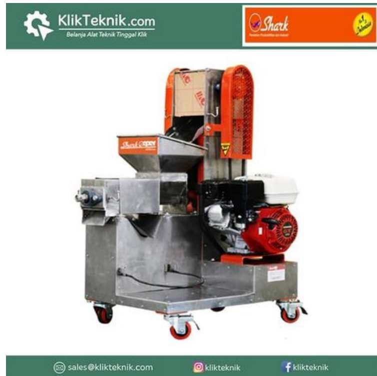
Gambar I.1 Mesin Pamarut dan Pemas Santan Berpenggerak Mesin Bensin (Sumber: https://www.tokopedia.com/klikteknik/shark-paper-mesin-parut-dan-peras-santan-kelapa )
