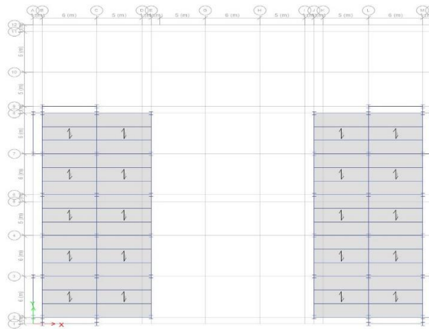
Gambar 1.8 Denah lantai 4-6 Model 1 ( Breising di sudut-sudut bangunan)
