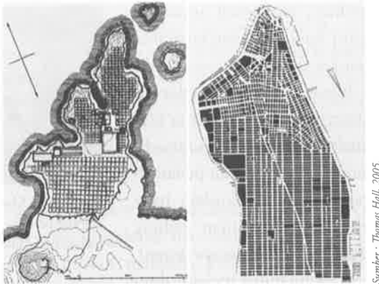
Gambar 1.2 Dua model fenomenologis perencanaan kawasan kota dengan metoda grid-planning . Gambar kiri merupakan kawasan kota Miletus (90 ha/220 acres), direncanakan oleh The Greek Planner Hippodamus pada abad V SM. Gambar kanan merupakan kawasan Manhattan, New York pada awal abad XIX (1811).
