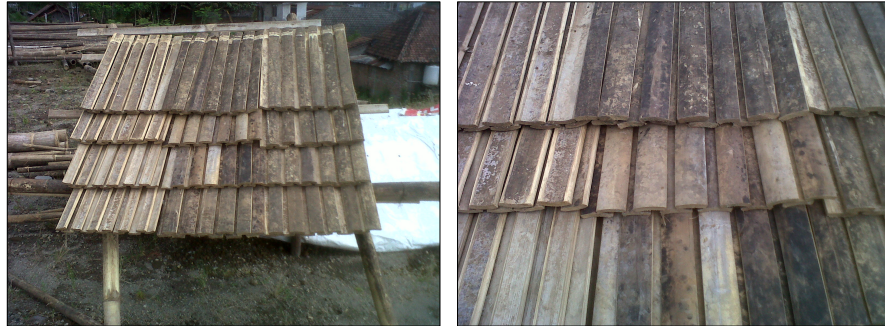
Panel sirap bambu penelitian Eugenius Pradipto Sumber: Dokumentasi Eugenius Pradipto
