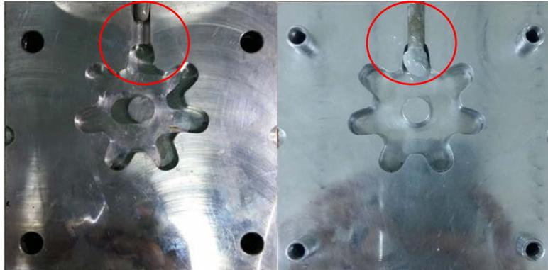
Gambar I.6 Contoh Hasil *Extrusion* dengan Pengisian Tidak Sempurna
