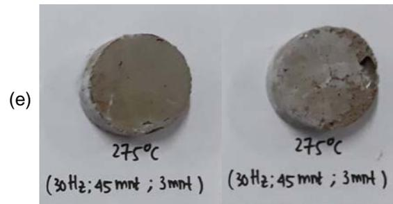
Gambar III.17 Hasil *Extrusion* dengan Frekuensi 30Hz dan Temperatur *Barrel*
