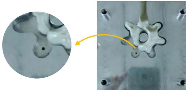
Gambar III.6 Posisi Lubang Venturi Cetakan Gear
