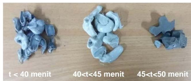
Gambar III.16 Hasil Uji Coba PET *Flakes* dengan Variasi Waktu Proses *Barrel*
