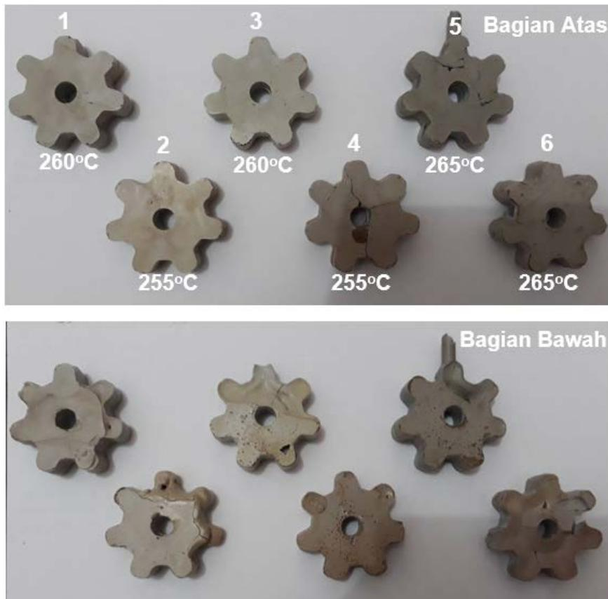
Gambar III.11 Produk Hasil Percobaan Setelah Modifikasi II dan Proses Perakitan
