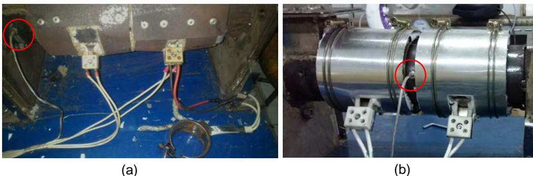
Gambar III.8 Perubahan Posisi Penempatan *Termocouple* (a) Awal (b) Akhir
