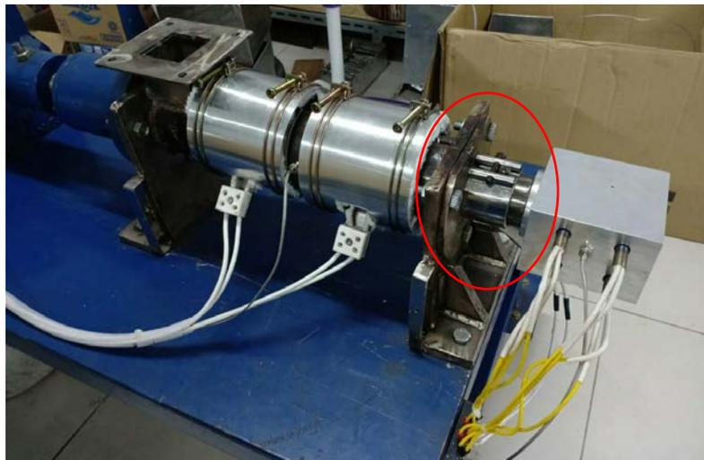
Gambar III.13 Konstruksi Mesin Sebelum Modifikasi Bagian *Nozzle*
