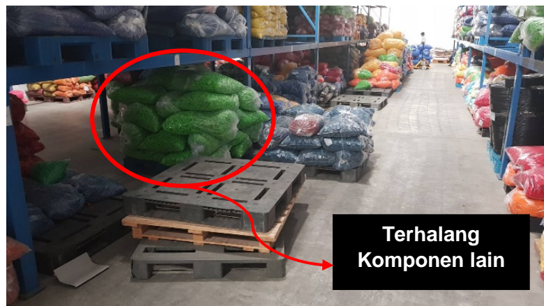
Gambar 1.2 Komponen yang Diletakkan Pada Gang
