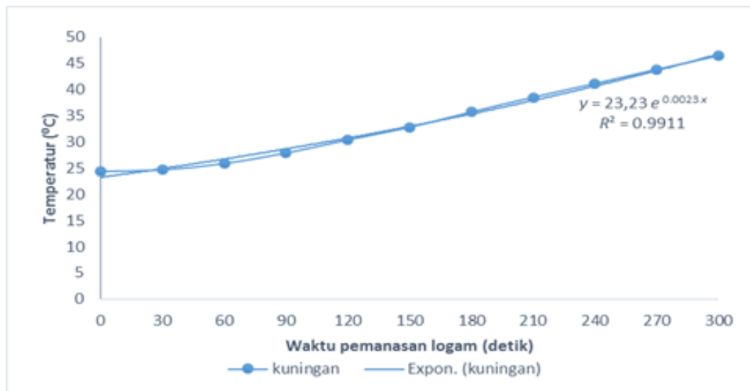
Gambar 4. (color online) Grafik kenaikan temperatur logam terhadap waktu pemanasan logam
