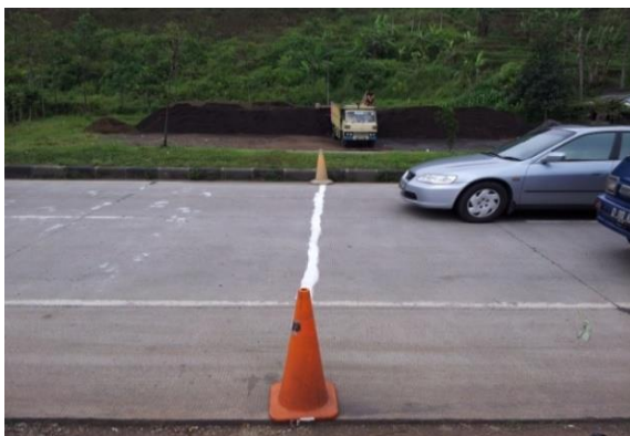
Gambar 4. Ilustrasi pengambilan data waktu tempuh kendaraan pada traffic cone pertama
