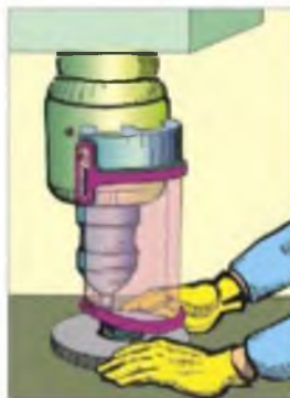
Gambar 7. Pelindung atau barrier untuk mesin
