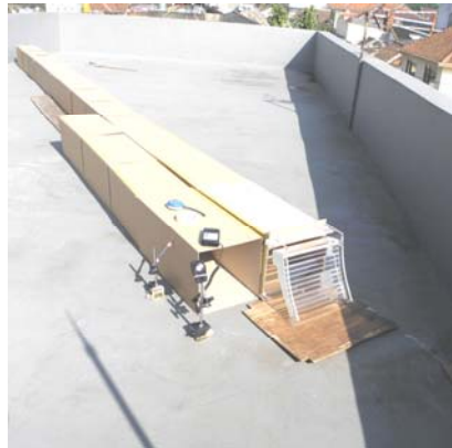
Gambar III.4. Penempatan pipa cahaya horisontal sesuai dengan arah sudut datang cahaya matahari
