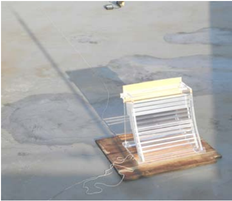
Gambar III.3. Penempatan model sesuai dengan arah sudut datang cahaya matahari
