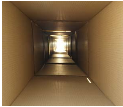
Gambar III.7 Kondisi di dalam model pipa cahaya horisontal dengan model pk.08.00 WIB di kedalaman 7,8 meter
