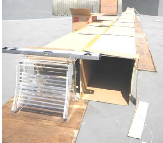
Gambar III.10 Penempatan model yang sudah disesuaikan dengan arah sudut datang cahaya matahari pk.10.00WIB
