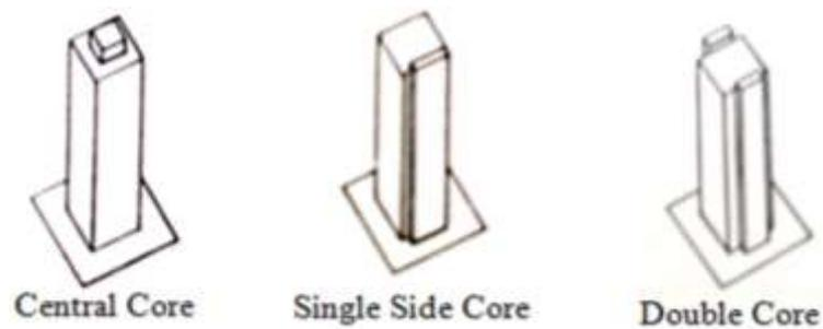
Gambar 2.1 Tiga tipe perletakan core pada bangunan tinggi. (Yeang, 1994).
