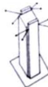
Gambar 2.2 Penempatan zona servis pada sisi luar bangunan memungkinkan untuk pencahayaan dan ventilasi alami. (Yeang, 1994).
