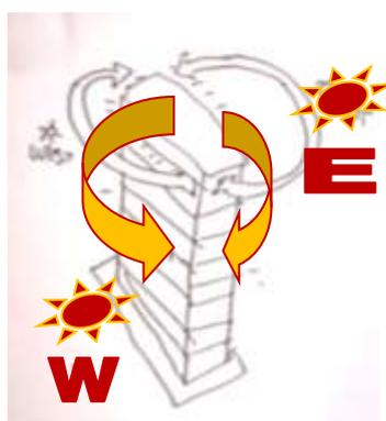
Gambar 3.2.4 Radiasi matahari pada semua sisi bangunan yang berbentuk persegi.
