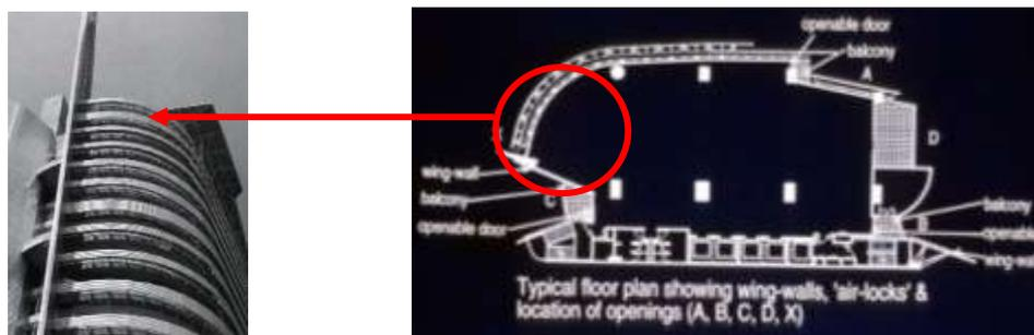
Gambar 3.3.2 *Wind wing walls* dikombinasikan dengan zona transisi sebagai penangkap angin ke dalam bangunan dan prinsip *air lock* pada *wind wing walls*.
