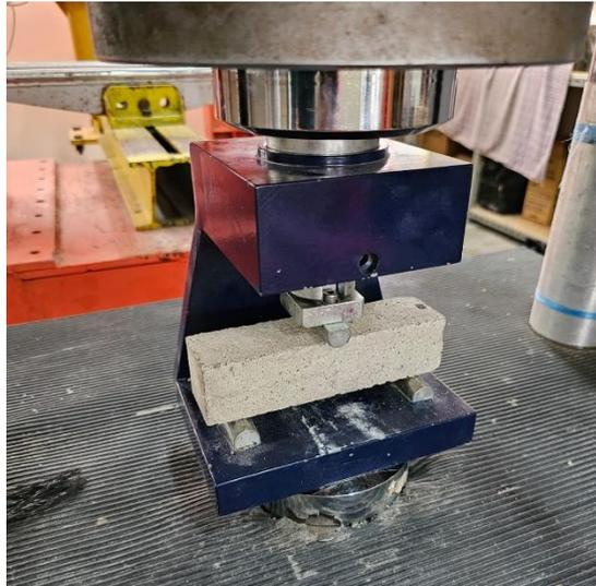
**Gambar 3.11** Pengujian Kekuatan Lentur
