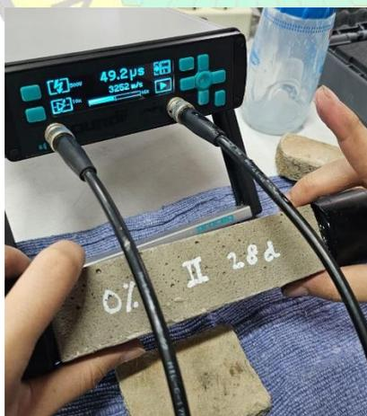
**Gambar 3.16** Pengujian UPV
