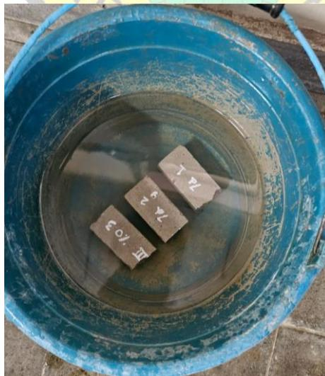
**Gambar 3.17** Pengujian Absorpsi
