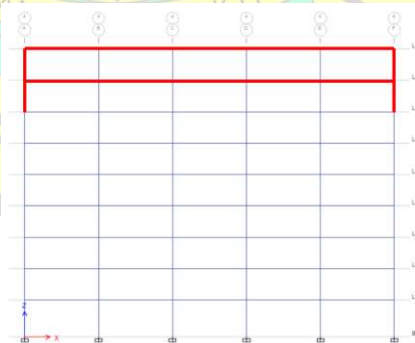
Gambar 1.8 Elemen Struktur Yang Mengalami Penurunan Kekuatan Akibat Kebakaran Lantai 7-8-9
