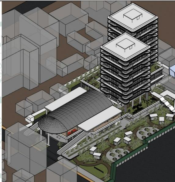
Penggunaan atap bentang lebar lengkung dengan struktur space frame dan atap datar dengan struktur beton pada massa *transit hub*.
