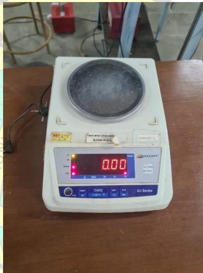
Gambar 3.6 Timbangan dengan ketelitian 0,01 gr
