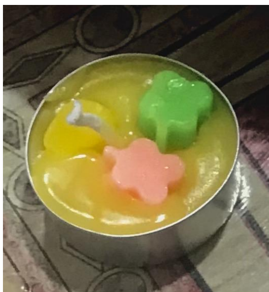
Gambar 1. 5 Cacat Permukaan Lilin Tidak Rata
