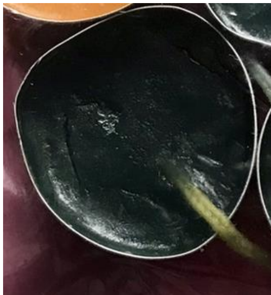
Gambar I. 6 Cacat Lilin Penyok
