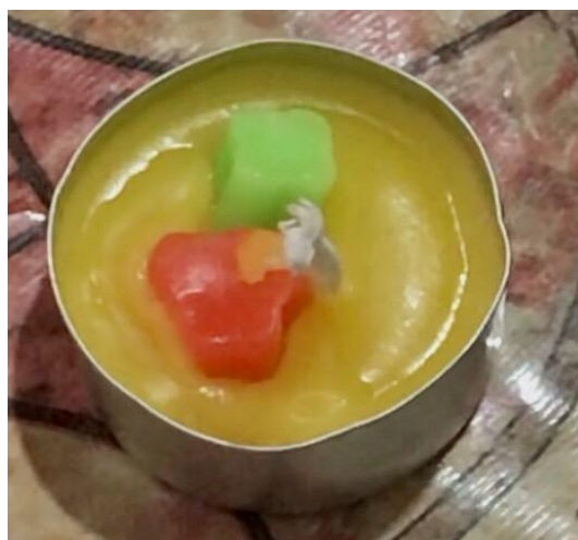
Gambar I. 4 Cacat Lilin Tidak Memenuhi Cetakan
