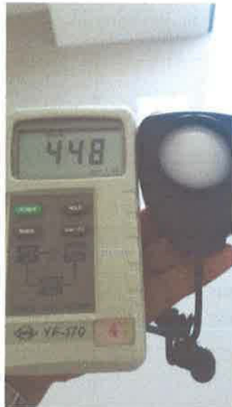
Gambar 1.2 Alat Ukur Kuat Penerangan Lux Meter (sumber: foto lapangan tahun 2017)
