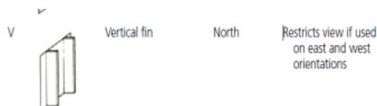
Gambar 5.6 Bentuk Peneduh (Kisi - Kisi Vertikal)
