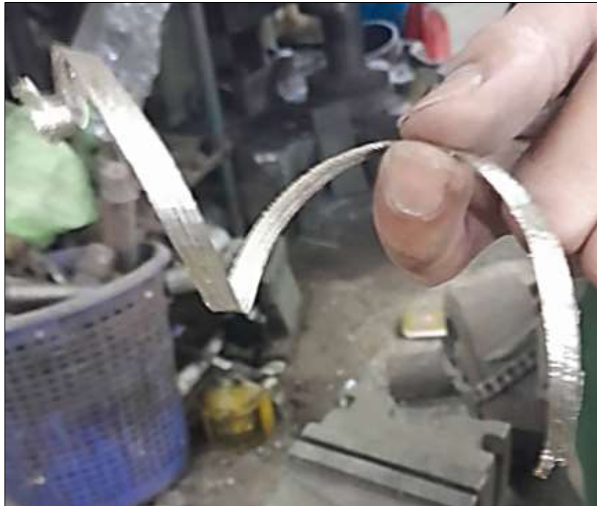
Gambar I.8 Serpihan Besi yang Mengenai Tangan Pekerja
