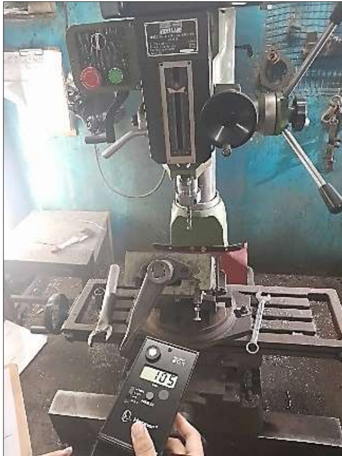
Gambar I.14 Uji Hasil Pengukuran Pencahayaan pada Area Mesin
