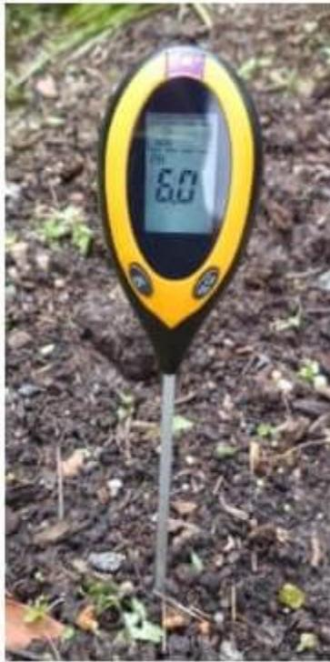
*Gambar 3.3 pH meter tanah*
