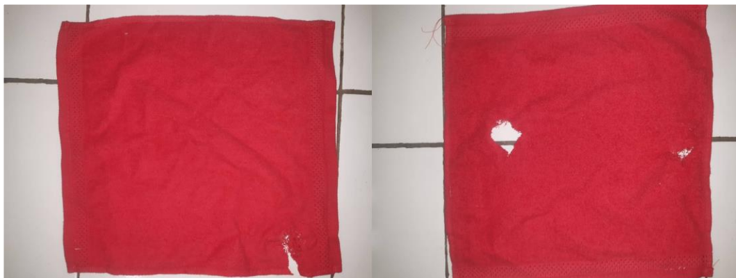
Gambar I.1 Contoh Produk Handuk Cacat dari CV X. Handuk Robek (Kiri) dan Handuk Berlubang (Kanan)
