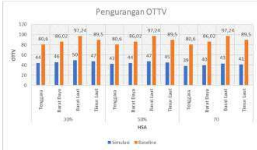
**Gambar 6. 7.** Perbandingan Nilai OTTV pada Penambahan Sirip Vertikal
