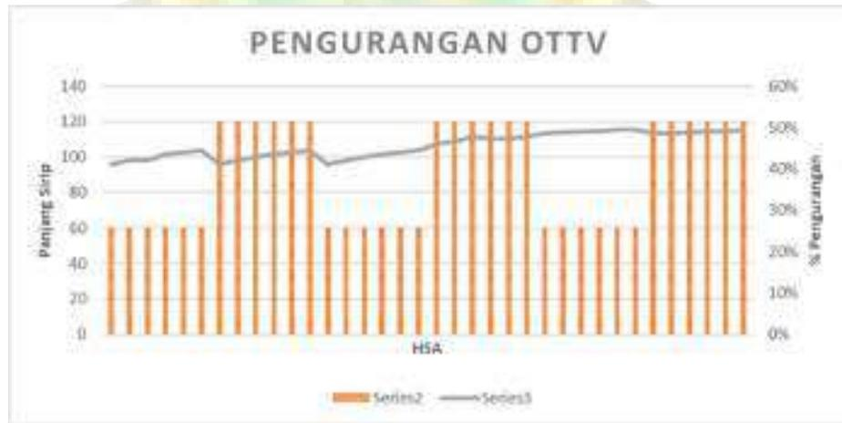
**Gambar 6. 6.** Grafik Pengurangan Nilai OTTV pada Simulasi Penambahan Sirip Vertikal
