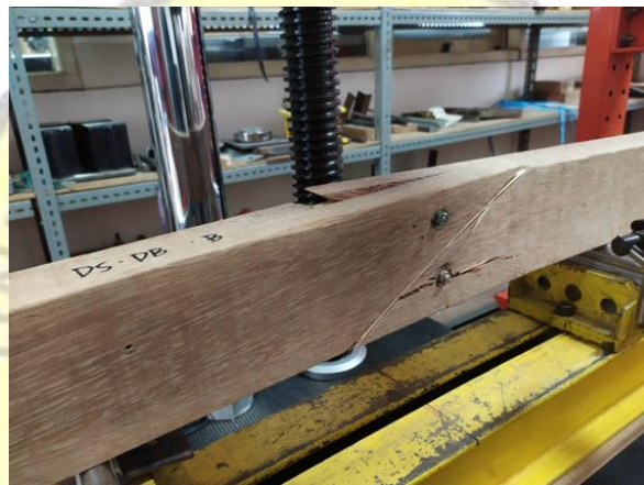
Gambar L1.4 Balok Kayu DS-DB-B Setelah Pembebanan
