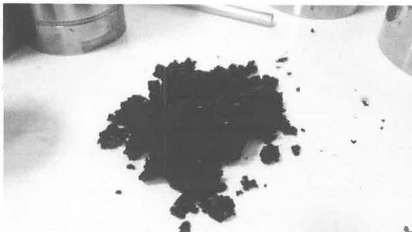
**Gambar 4.2** Karbon Hasil *Hydrothermal Carbonization*
