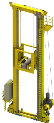
Gambar 1.1: Contoh mesin stacker crane yang digunakan pada AS/RS [6].
