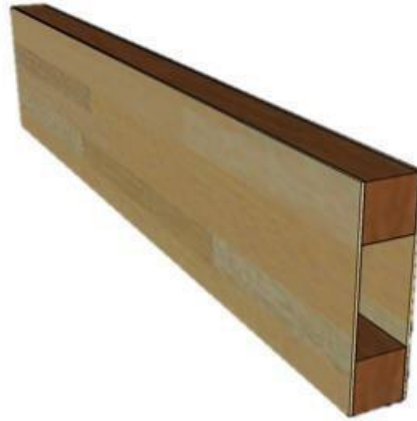
Gambar 1.1 Balok Berpenampang Boks (Menggabungkan kayu solid jenis borneo dengan plywood pada kedua sisi dan menggunakan sambungan bibir lurus pada tengah bentang)
