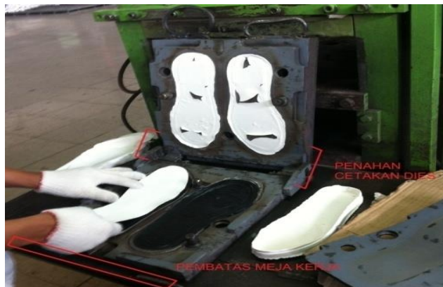
Gambar 4. Penahan cetakan dies dan pembatas meja kerja
