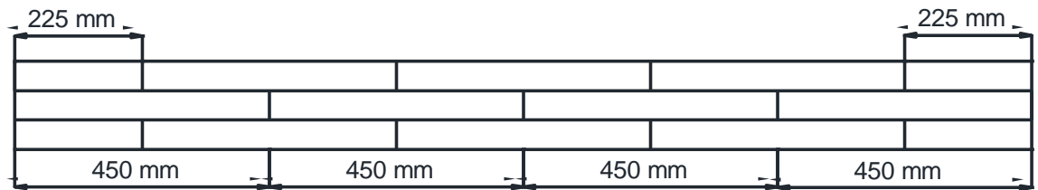
Gambar 1.6.b Posisi Sambungan Benda Uji Variasi 2
