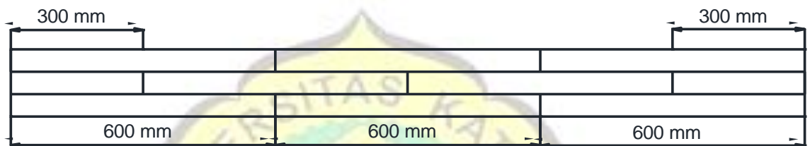
Gambar 1.6.c Posisi Sambungan Benda Uji Variasi 3
