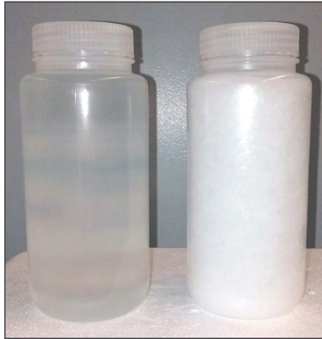
Gambar 1.2. Phase Change Material kondisi fasa cair (kiri) dan kondisi fasa padat (kanan)
