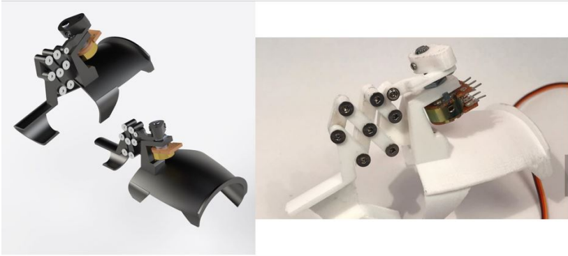
Gambar 5.2: Referensi desain mekanika untuk pontensiometer sebagai penggerak pada tangan prostetik "YouBionic" [15].
