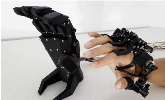
Gambar 5.1: Referensi desain tangan prostetik "YouBionic" menggunakan potensiometer sebagai pemicu gerakannya [15].
