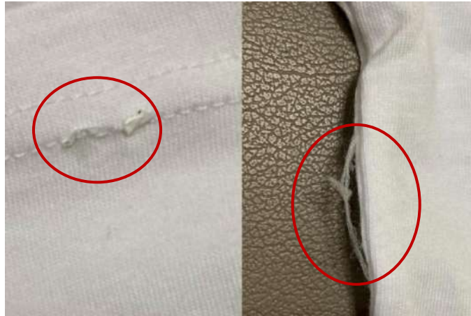
Gambar I.3 Jahitan Tidak Rapi
