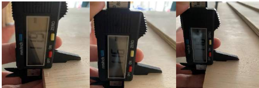
Gambar I.3 Pengukuran Ketebalan 3 Buah Sampel Tripleks 12mm
