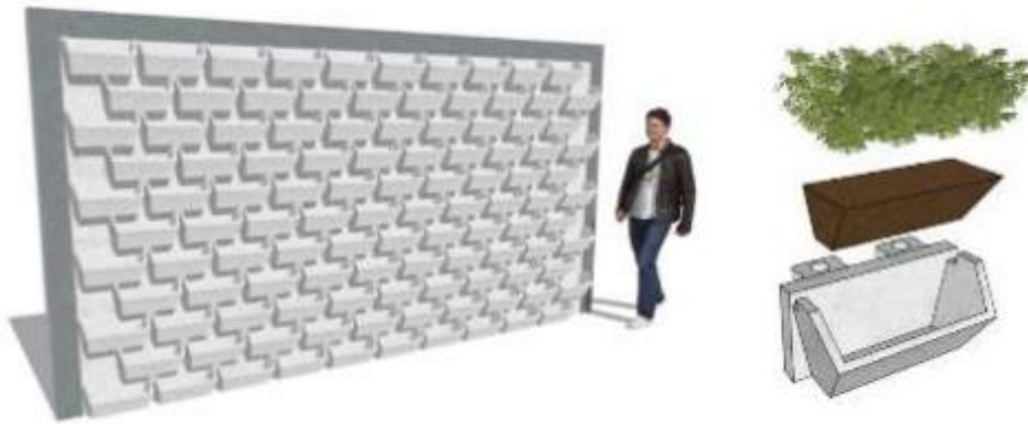
Gambar 1.1 Rancangan Sistem Konstruksi Vertical Garden (Philipus, 2018)
