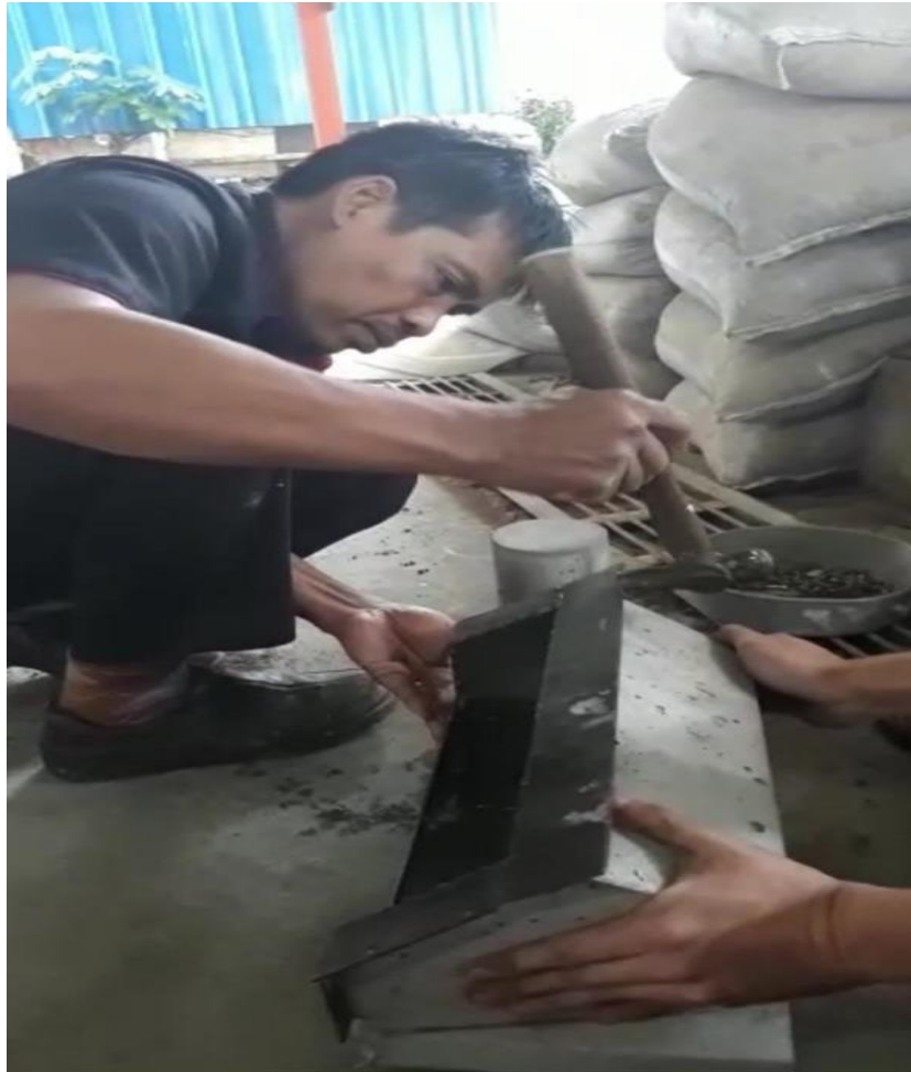
Lampiran 4 Pelepasan Modul Growblock dari Cetakan
