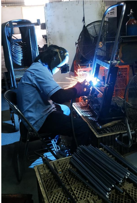
Gambar I.4 Stasiun Kerja Pengelasan Rangka Kursi Lipat FN di CV. Y (Sumber: Dokumentasi pribadi)
