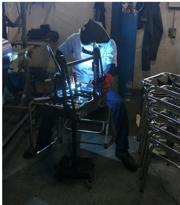
Gambar I.5 Stasiun Kerja Pengelasan Rangka Kursi Lipat FN di CV. Z (Sumber: Dokumentasi pribadi)
