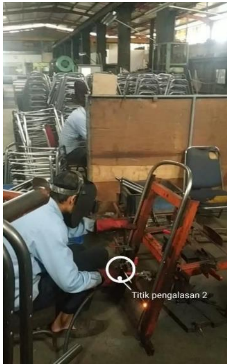
Gambar I.3 Bagian Kursi Lipat FN yang Dilas di PT. X (Sumber: Dokumentasi pribadi)
