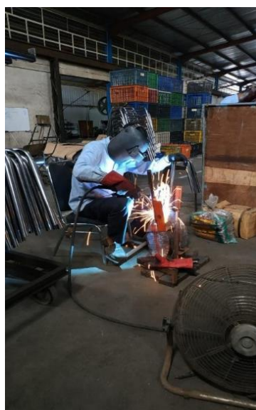
Gambar I.2 Stasiun Kerja Pengelasan Rangka Kursi Lipat FN di PT. X (Sumber: Dokumentasi pribadi)
