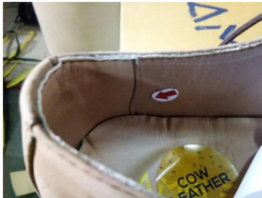
Gambar I.4 Penempelan Insole yang Tidak Rapi
