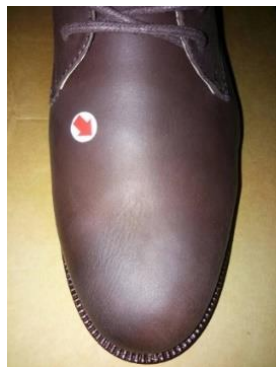
Gambar I.3 Guratan pada Permukaan Kulit Sepatu
