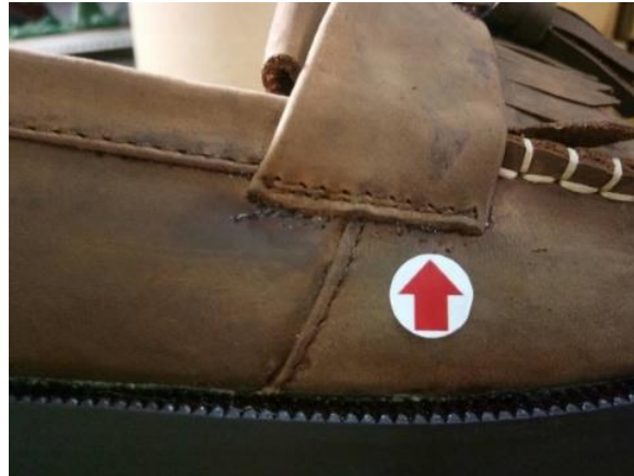
Gambar I.1 Cacat Lubang pada Sepatu
