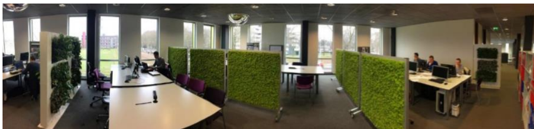
Gambar 1.2. Penggunaan Mosswall dan Greenwall sebagai sekat askutik (sumber:Kalle, Quantifying the acoustical properties of internal vegetation screens )
