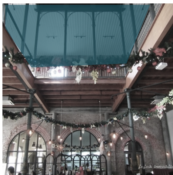
Gambar 5.2 Saran Penutupan Void Untuk Meredam Kebisingan
