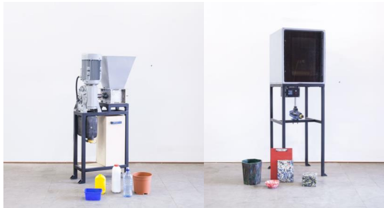
Gambar 1.2 Shredder Machine (Kiri) dan Compression Machine (Kanan) Karya Dave Hakkens (Sumber: Precious Plastic , 2017)
